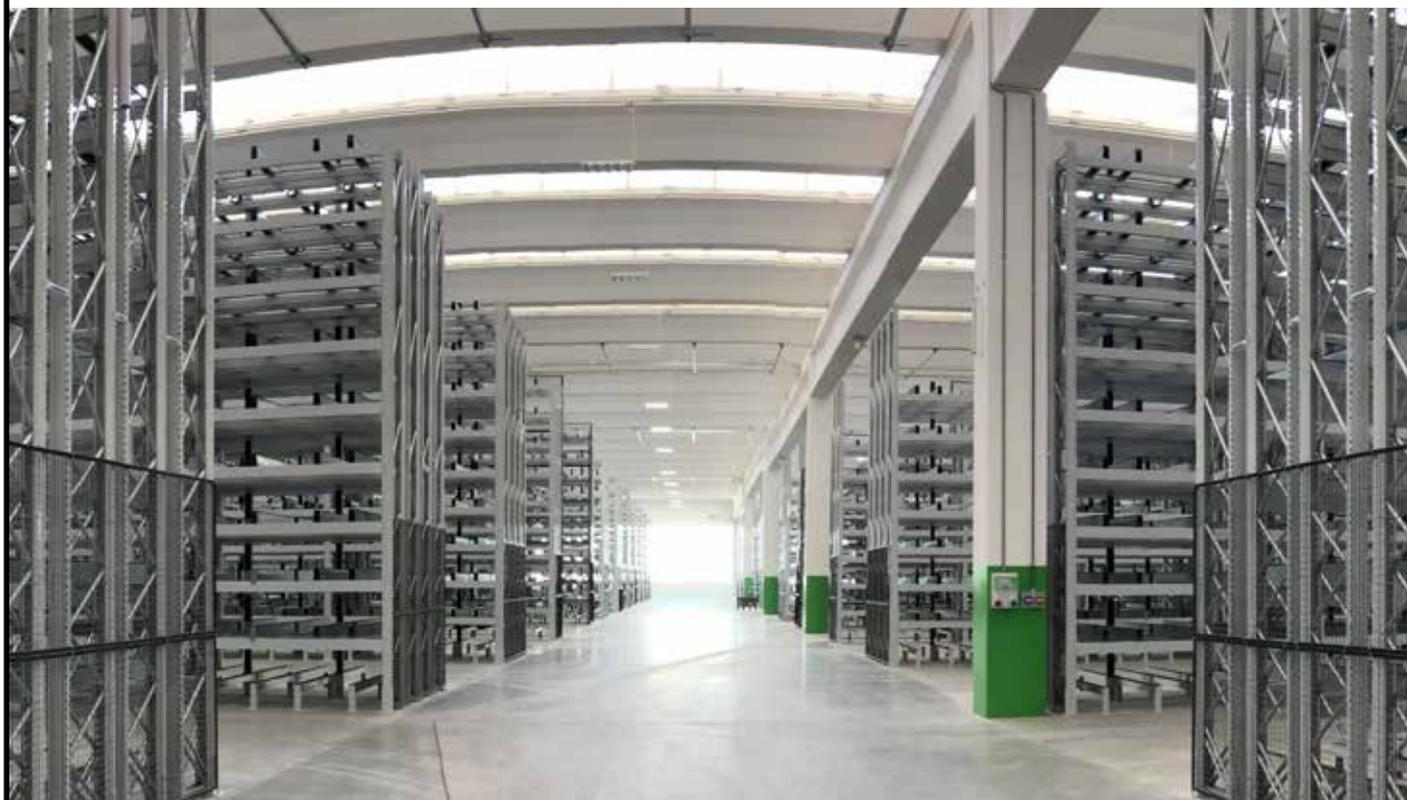
Il modulo base è composto da **due coppie di spalle di 700 mm di larghezza**, ciascuna costituita da due **montanti in profili d'acciaio alto resistente** forati formati a freddo, collegati da un traliccio composto da elementi tubolari in acciaio zincato, bullonati ai montanti.
