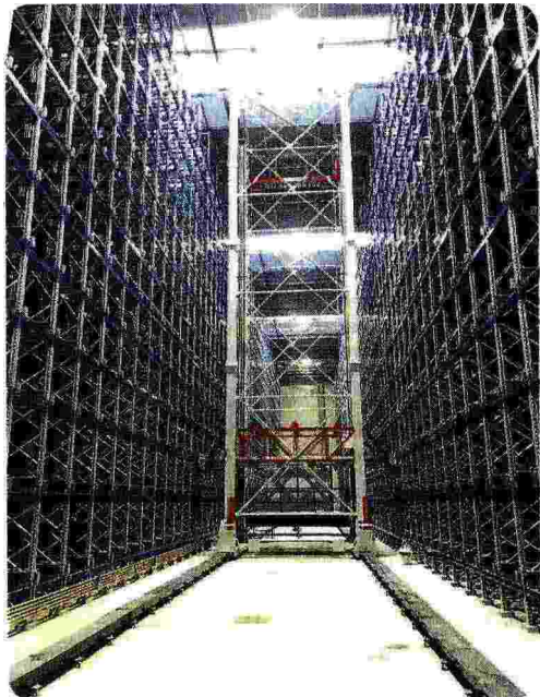
Trasloelevatore e navetta per colli lunghi fino a 6200 mm (Altezza 16 metri circa)
